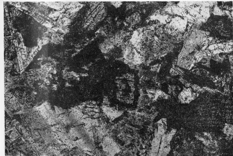
Fig. 7. Diabasa. Labradorita, augita y magnetita, mostrando exsolución entre magnetita y augita y alteración de esta última. Luz polarizada, 119.77X.
