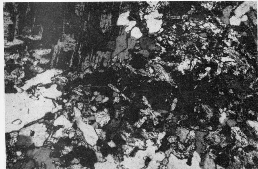
Fig. 3. Granito, mostrando cristales de ortoclasa, cuarzo, titanita y clorita. Luz polarizada, prismas cruzados, 93.59X.
