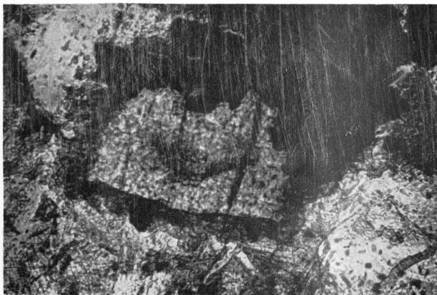
Fig. 8. Diabasa, mostrando ex-solución o cristalización a tiempos diferentes de magnetita y augita y alteración de esta última, posiblemente a anfíbola. Luz polarizada, 380.31X.
