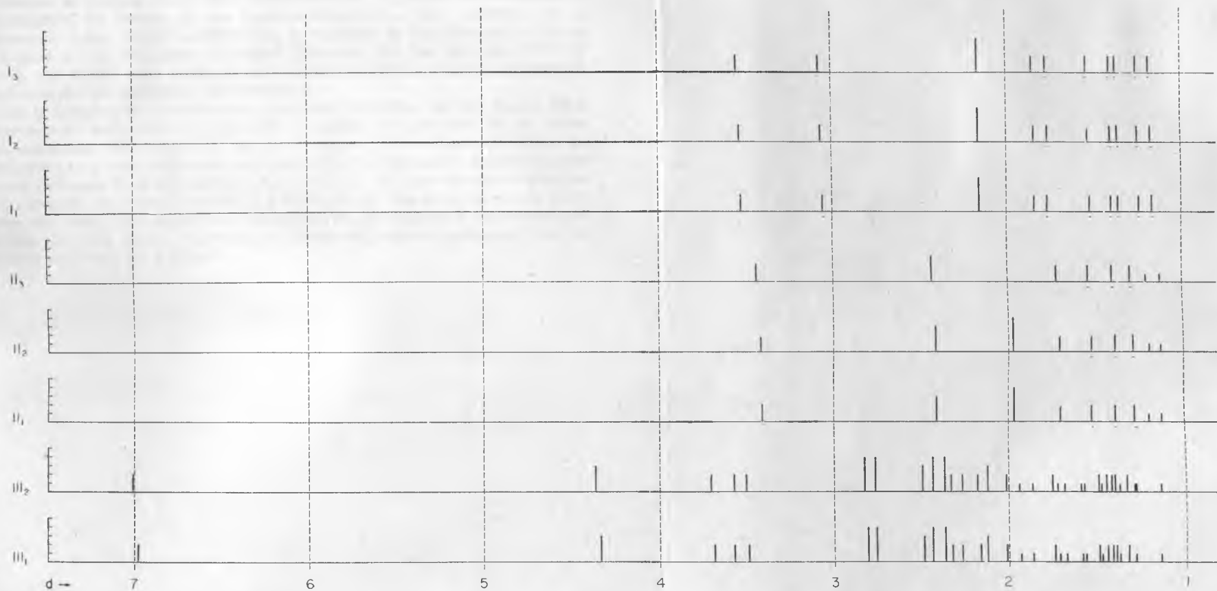
Fig. 18. Cuadro sinóptico de los diagramas de jalpaíta (fase \alpha del sistema Ag-Cu-S) con las modificaciones indicadas en la tabla correspondiente. Los diagramas se construyeron en función de d , superior a 1.000.
