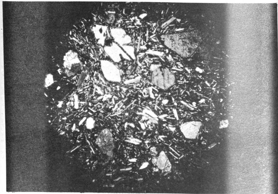
Foto 4. Microfotografía de una muestra del derrame TH7. Basalto alcalino de olivino. Numerosos cristales de clinopiróxenos (augita) y olivino en una matriz hecha por microlitas de andesita y labradorita. Nicoles cruzados.
