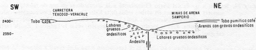
Figura 26. Sección a través de la Falla Hacienda La Flor al suroriente de Tepetlaoxtoc, unos 1,500 m hacia el oriente de la sección de la Figura 25, que muestra las relaciones en ambos lados de la falla. Para la localización de la sección, véase la Lámina 1. Escala vertical igual que la horizontal.
