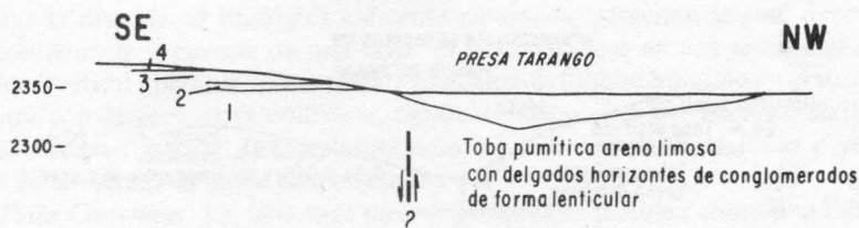
Figura 19. Sección a través de la Presa Tarango que muestra la litología en ambos lados de la Falla Texcalatlaco. 1= toba pumítica (30 m); 2= pómez (2.0 m); 3= conglomerado (10 m); 4= toba café (15 m). Para la localización de la sección, véase la Lámina 1. Escala vertical igual que la horizontal.
