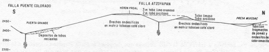
Figura 16. Sección desde el ramal noroccidental de la Barranca del Muerto hasta la Presa Mixcoac, a través de las Fallas Atzoyapán y Puente Colorado. Para la localización de la sección, véase la Lámina 1. Escala vertical igual que la horizontal.
