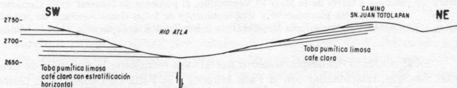
Figura 28. Sección a través de la Falla Hacienda La Flor al suroriente de Tepetlaoxtoc, cruzando el cauce del Río Atla y mostrando la posición estructural de tobas en ambos lados de la falla. Para la localización de la sección, véase la Lámina 1. Escala vertical igual que la horizontal.
