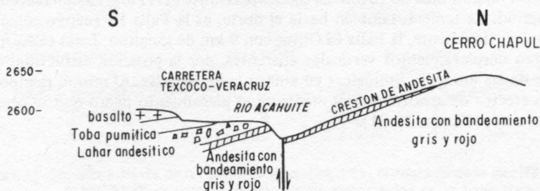
Figura 27. Sección a través de la Falla Hacienda La Flor al suroriente de Tepetlaoxtoc, cruzando el cauce del Río Acahuite y mostrando las relaciones en ambos lados de la falla. Para la localización de la sección, véase la Lámina 1. Escala vertical igual que la horizontal.
