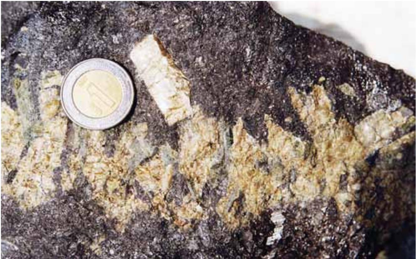
Figura 32. Detalle del cuerpo de brecha que muestra un intercrecimiento de cristales de apatita y piroxeno, Peña Colorada, área de La Chula. Se aprecian cristales prismáticos de apatita (color gris claro) y cristales piramidales de piroxeno (color gris medio), en una matriz de magnetita de textura de grano grueso.
