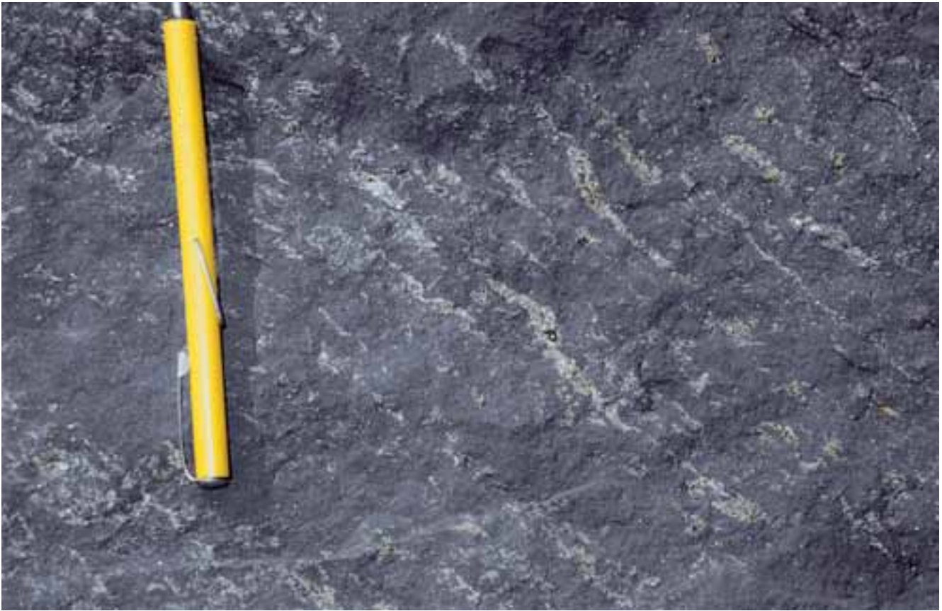
Figura 28. Vetillas y diseminación de pirita, en color gris claro, en el cuerpo central de mena de hierro, en color gris oscuro. Peña Colorada, área de Chinforinazo Centro.
