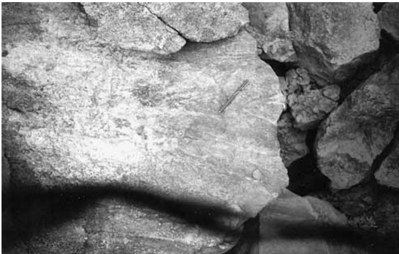
Figura 21. Detalle del cuerpo inferior bandeado del yacimiento de Peña Colorada. Se aprecia diastratificación en las capas de magnetita en color gris oscuro y en tobas de color gris claro.
