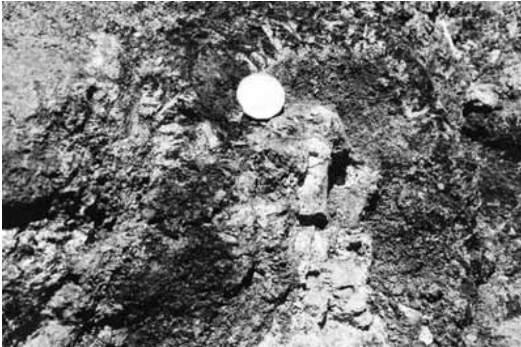
Figura 47. En la parte central de la fotografía se observa un fragmento de riodacita (color gris claro) y a su alrededor, en forma radial, se advierten cristales de piroxeno (color gris claro) en matriz de magnetita (color gris oscuro). Cerro de Mercado, Durango, parte central del yacimiento.
