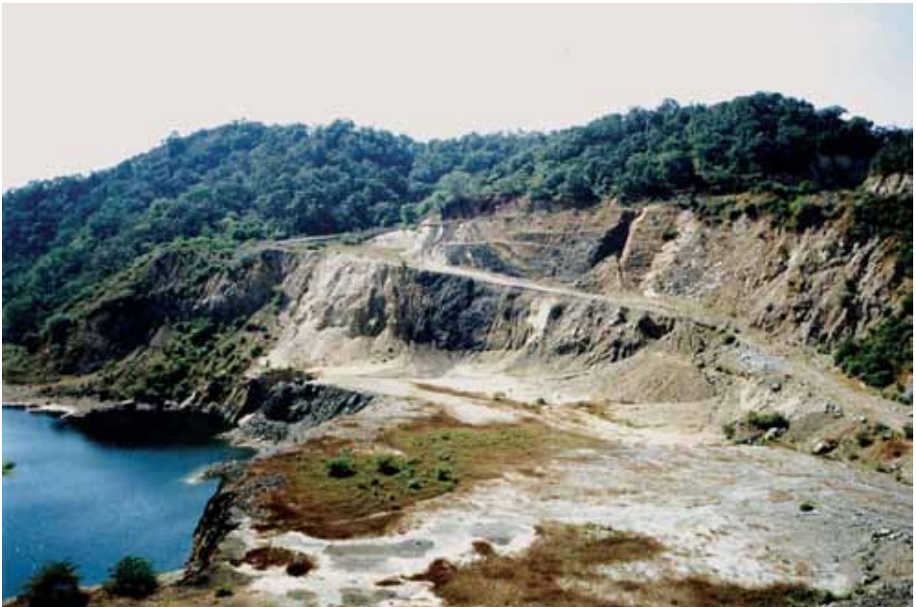
Figura 22. Panorámica del área de La Chula, Peña Colorada, donde se observa, en color oscuro, el cuerpo masivo, tabular y subvertical, de hierro. A la izquierda, el cuerpo está en contacto por falla con granito (de color claro); a la derecha, el contacto es aparentemente concordante con tobas andesíticas (de color gris claro).
