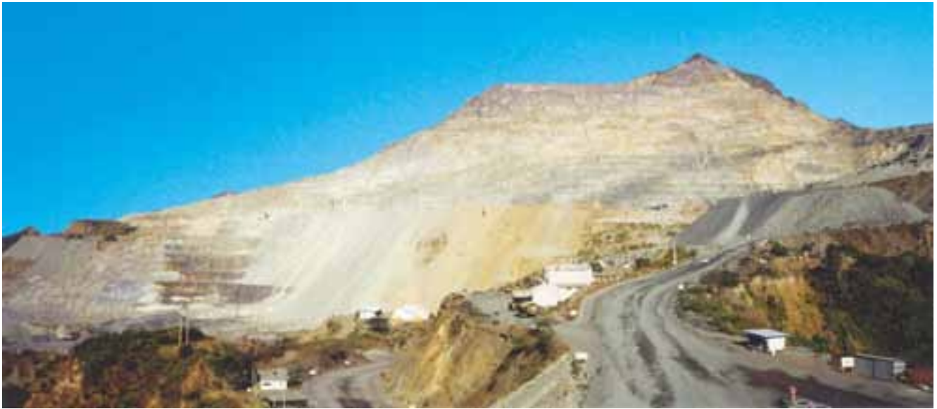
Figura 17. Panorámica del yacimiento de Peña Colorada en la que se observan los cuerpos principales de mineral de hierro. A la derecha, se observa el cuerpo principal de mena de hierro, concordante a la estratificación de las tobas, que constituyen la parte media del cerro Los Juanes. En la parte izquierda se observan los cuerpos laterales.
