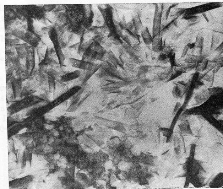
Figura 6. Micrografías electrónicas de la arcilla interestratificada mica-montmorillonita de Pathé, Hidalgo.
