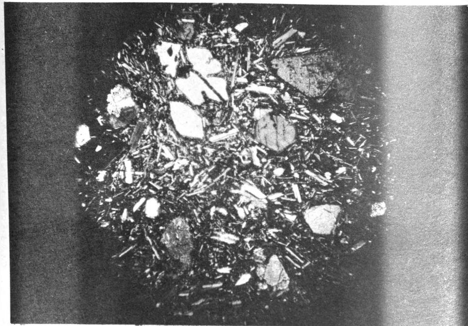
Foto 4. Microfotografía de una muestra del derrame TH7. Basalto alcalino de olivino. Numerosos cristales de clinopiróxeno (augita) y olivino en una matriz hecha por microlitas de andesita y labradorita. Nicoles cruzados.
